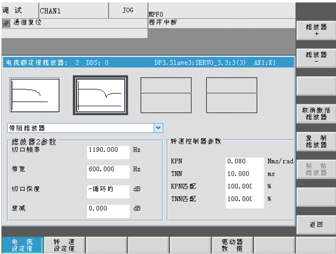
图 8-22 带阻为 1190 Hz 的转速调节回路过滤器
